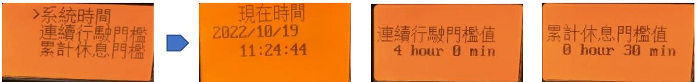
在系統參數選單下，選擇時間相關設定之系統時間，連續行駛門檻及累計休息門檻皆設有預設值，無法手動調整。此外，系統時間為衛星定位反饋時間，每次開機皆會自動校正，若有需要更動，則需請捷世林資訊工程師按照客戶需求調整設定。
